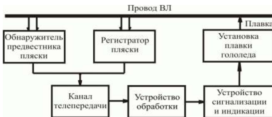
Рисунок 1 – Функциональная схема системы мониторинга пляски проводов и грозотросов ВЛ с автоматической адаптивной плавкой отложений.
